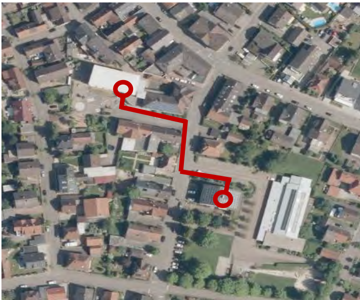
Abbildung 67: Dezentrales Nahwärmenetz Gebiet Rathaus – Szenario 1 – „Minimalszenario“:
